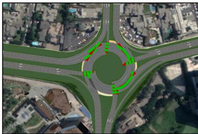
Fig. 13. Definición de áreas de conflicto dentro de la Turbo Rotonda
