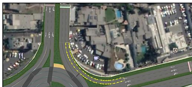
Fig. 14. Definición de contadores y tiempos de viaje para cada acceso de la Turbo Rotonda
