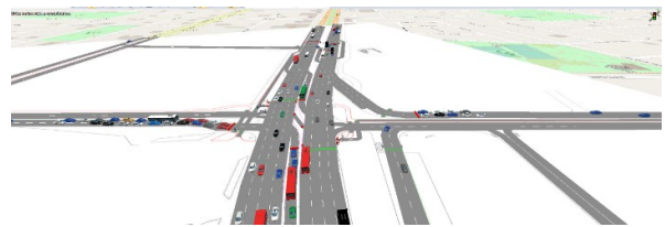
Figure 9: Modelo de la alternativa RCUT y funcionamiento en 3D/ Fuente: Elaboración Propia en Vissim
